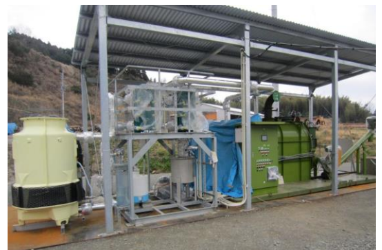
EFB 半炭化 試験機(100kg/h 処理)
